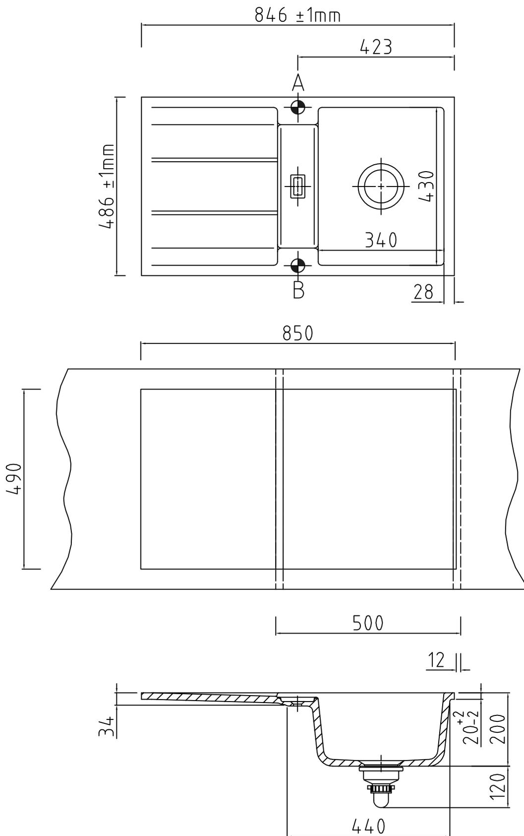
Keine Armaturbohrung vorhanden. Keine Sollbruchstellen. Bohrungen nach individueller Anordnung (● Pos. A und B, siehe Zeichnung).
