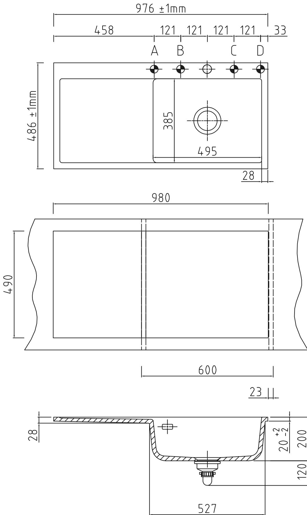
● Armaturbohrung vorhanden. Keine Sollbruchstellen. Bohrungen nach individueller Anordnung (● Pos. A, B, C und D, siehe Zeichnung).
